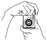
Lorsque vous prenez des photos verticales, le flash doit être au-dessus de l'objectif. Tenez bien l'appareil photo avec les deux mains.
