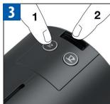
Houd de Espresso toets ingedrukt en schakel tegelijk de spanning van de machine in. Wacht totdat er geen water meer uit de uitloop stroomt.
