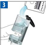
Remplissez le réservoir d'eau de 0,5 l d'eau et ajoutez le liquide de détartrage Nespresso.
