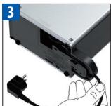
Faites passer le reste du câble dans le guide câble sous la machine et remettez la machine droite.
