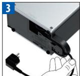
Plaats het resterende deel van de kabel in de daarvoor voorzorgde kabelklemmen aan de onderzijde van de machine en zet de machine vervolgens weer rechtop.
