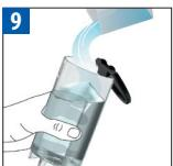
Remplissez de nouveau le réservoir d'eau avec la solution de détartrage usagée, collectée dans le récipient et répétez une fois l'étape 8.
