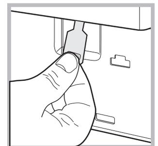
4. se servir de la languette indiquée, tirer vers soi jusqu'à ce que le tirant en plastique se dégage de son cran d'arrêt; tirer ensuite vers le bas et ouvrir la porte en même temps.
