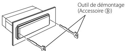
3. Baissez l'outil de démontage vers le bas et tirez l'appareil à moitié en faisant pression vers l'intérieur.
