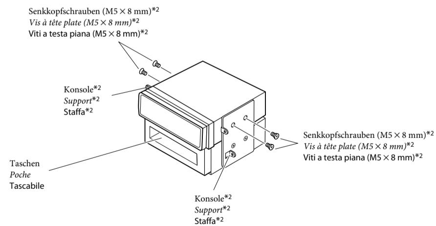
**Hinweis :** Beim Anbringen des Geräts an der Konsole sicherstellen, daß 8 mm lange Schrauben verwendet werden. Werden längere Schrauben verwendet, können sie das Gerät beschädigen.
