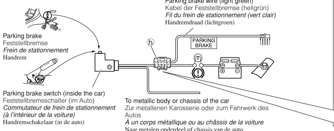
**How to connect the crimp connector / Anschließen des Crimpanschlusses / Comment utiliser le raccord à sertir / Gebruik van de versteviging voor aansluitingen**
