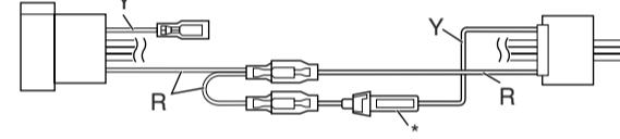
**Connecting the parking brake wire / Das Kabel der Feststellbremse anschließen / Connexion du cordon de frein de stationnement / Aansluiten van het handremdraad**
