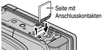
\* Schalten Sie das Gerät aus, bevor Sie eine Karte einsetzen oder entnehmen.
