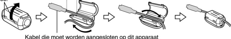
Kabel die moet worden aangesloten op dit apparaat
