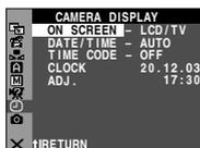
**5** Appuyer sur + ou – pour sélectionner "CLOCK ADJ." et appuyer sur **SELECT/SET**. Le paramètre pour le "jour" est illuminé.
