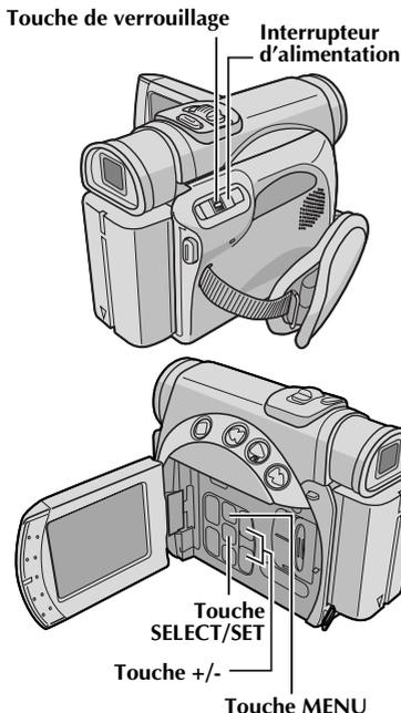
**1** Régler l'interrupteur d'alimentation sur "M" tout en appuyant sur la touche de verrouillage située sur l'interrupteur.
