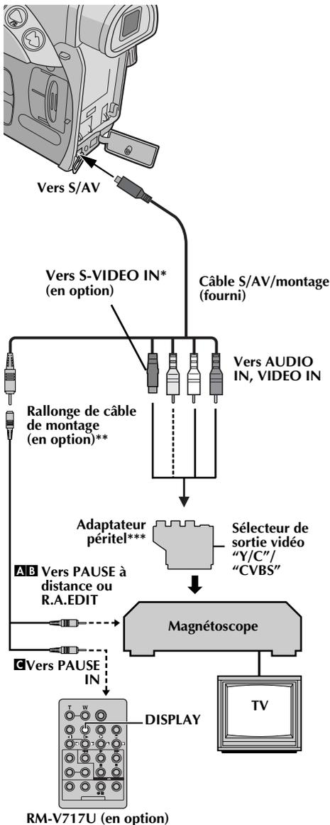
\* À raccorder si votre téléviseur ou votre magnétoscope possède un connecteur S-VIDEO IN. Dans ce cas, il n'est pas nécessaire de raccorder le câble vidéo jaune.
