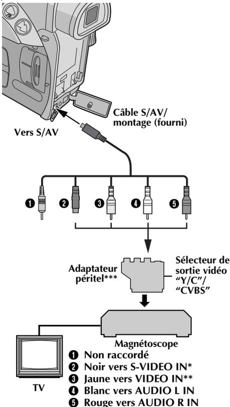
\* À raccorder si votre téléviseur ou votre magnétoscope possède des connecteurs S-VIDEO IN et A/V. Dans ce cas, il n'est pas nécessaire de raccorder le câble vidéo jaune.
