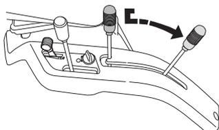
Le levier peut également être utilisé pour régler provisoirement la hauteur de la coupe, par exemple dans le cas d'un léger renflement de la pelouse.
