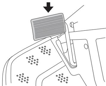
L'entraînement des coupeaux n'est pas modifié par la pédale de débrayage.
