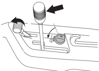
**Pour le Rider 111B** Repousser la commande d'accélération et tourner la clé de démarrage sur la position "STOP".
