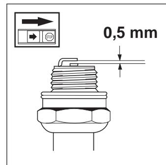
Ces facteurs causent une déposition sur les électrodes de la bougie d'allumage, pouvant entraîner des problèmes de service et des difficultés de démarrage.
