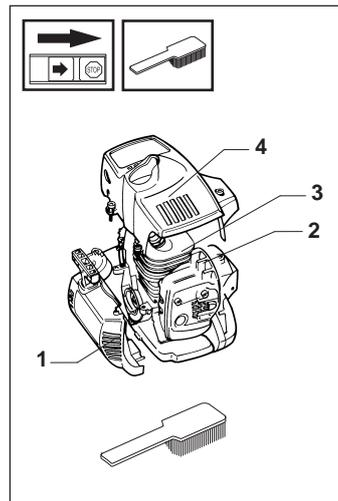
A l'aide d'une brosse, nettoyez le circuit de refroidissement une fois par semaine, en cas de conditions de service difficiles, plus souvent. **Un circuit de refroidissement encrassé ou obstrué entraîne une surchauffe du moteur pouvant résulter en des dommages au cylindre et au piston.**
