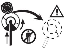
• Les machines équipées d'une lame d'éclaircissage ou à herbe peuvent projeter violemment sur le côté lorsque la lame rencontre un objet dur. La lame peut sectionner les bras ou les jambes. S'assurer que les personnes ou animaux restent à 15 mètres au minimum de la machine. Pour utiliser une lame d'éclaircissage ou à herbe, la machine doit être munie d'un guidon, d'un protège-lame et d'un harnais adaptés.
