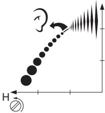
Le moteur ne doit pas être chargé lors du réglage du pointeau haut-régime H. Démonter l'équipement de coupe, l'écrou, la bride de support et le toc d'entraînement avant d'effectuer le réglage du pointeau haut-régime H.
