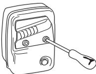
Si le silencieux de la machine est muni d'une grille antiflamme, il faut le nettoyer régulièrement. Une grille antiflamme bouchée entraîne une surchauffe du moteur pouvant provoquer des dommages graves.
