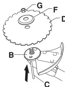
Les dents de la lame d'éclaircissage risquent de causer des blessures aussi bien lors du serrage que du desserrage de l'écrou de la lame. Veiller à ce que la main soit toujours protégée par le protège-lame lors de ces interventions. Toujours utiliser une clé à douille munie d'un manche assez long. La flèche sur l'illustration indique la zone dans laquelle la clé doit être utilisée, aussi bien pour serrer que pour desserrer l'écrou.
