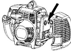
Cette silencieux sont munis d'une grille pare-étincelles. Cette grille doit être nettoyée une fois par mois. Utiliser de préférence une brosse en acier. **Si la grille est endommagée, elle devrait être remplacée.** Une grille antiflamme bouchée provoque la surchauffe de la machine et la détérioration du cylindre et du piston.
