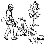
4. Lors des déplacements, arrêter le moteur. Lors des déplacements longs et des transports, utiliser le dispositif de protection prévu à cet effet.
