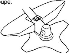
S'assurer que la protection est intacte et qu'elle ne présente pas de fissures. Remplacer la protection si elle a subi des coups ou si elle présente des fissures. Toujours utiliser la protection recommandée prévue pour l'équipement de coupe en question. Voir Caractéristiques techniques.
