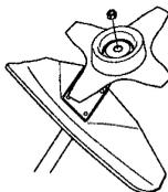
Pose: serrer l'écrou dans le sens contraire de la rotation de l'équipement de coupe.
