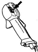
**REMARQUE!** L'interrupteur d'arrêt se remet automatiquement en position de démarrage. Toujours retirer le chapeau de bougie de la bougie lors du montage, contrôle et/ou entretien, afin d'éviter tout démarrage accidentel.
