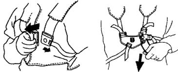
S'assurer du bon positionnement des bretelles du harnais. Quand le harnais et la machine sont ajustés, contrôler le bon fonctionnement du dispositif de libération rapide du harnais.
