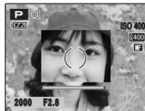
Réglez [VERIFICATION AF.] sur [OUI]. Vous pouvez effectuer un zoom avant sur le centre de l'image en tournant la bague de mise au point, ce qui facilite en outre la mise au point sur cette portion de l'écran. Prenez la photo, appuyez à mi-course sur le déclencheur ou laissez l'appareil photo pendant quelques instants afin qu'il revienne à l'affichage normal.
