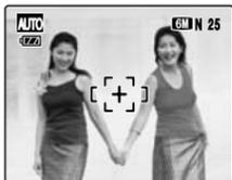
Dans la composition ci-dessus, les sujets (deux personnes ici) sont en dehors du cadre AF. Si vous appuyez maintenant à mi-course sur le déclencheur, les sujets ne seront pas mis au point.
