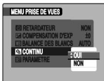
La prise de vues continue aussi longtemps que le déclencheur est maintenu enfoncé. Ce mode permet de prendre jusqu'à 1,7 images par seconde.
