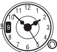
Pour la mise à l'heure, tirer la manette et tourner sur la droite jusqu'à lire l'heure exacte. Pour son utilisation comme minuteur, sélectionner une durée en tournant la manette dans le sens horaire (sans appuyer) jusqu'à lire dans la fenêtre le temps désiré (max. 180'). A la fin du temps, une sonnerie retentit et il vous faudra éteindre le four ; pour stopper la sonnerie tourner la manette sur .
