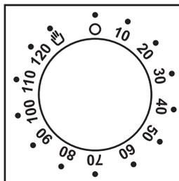
Il est possible de programmer la durée de la cuisson et l'extinction automatique du four (max. 120 minutes). À l'expiration du temps désigné, la manette sera en position O, une sonnerie retentira et le four s'arrêtera automatiquement. Si l'on souhaite utiliser le four sans programmer d'arrêt automatique, positionner la manette en position .
