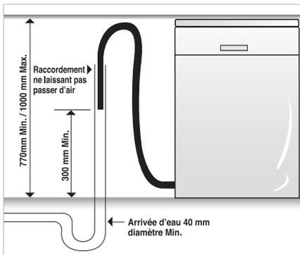
Schéma B : Raccordement au tout à l'égout
