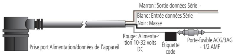
Les formats d'interface sont sélectionnés à la page Réglage de l'interface 'Interface Setup', voir page 56 de ce manuel. Les lignes d'entrée/sortie du GPSmap 60CS sont compatibles RS-232, permettant une interface facile avec une large gamme d'appareils externes, comprenant les PC, les récepteurs de balises différentiels, les pilotes automatiques de la marine et/ou un second récepteur GPS.
