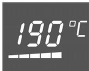
Le témoin de chauffe indique la montée en température dans le four. Le moment optimal pour enfourner le plat est atteint lorsque toutes les cases sont remplies.
