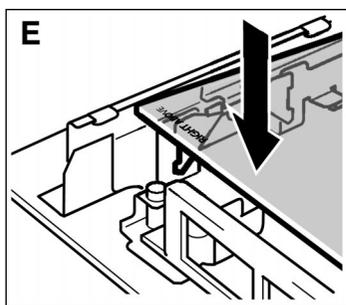
3. Appuyer fermement à l'avant sur la vitre, afin qu'elle s'enclenche. Vérifier que la vitre est fixée. (Fig. E)
