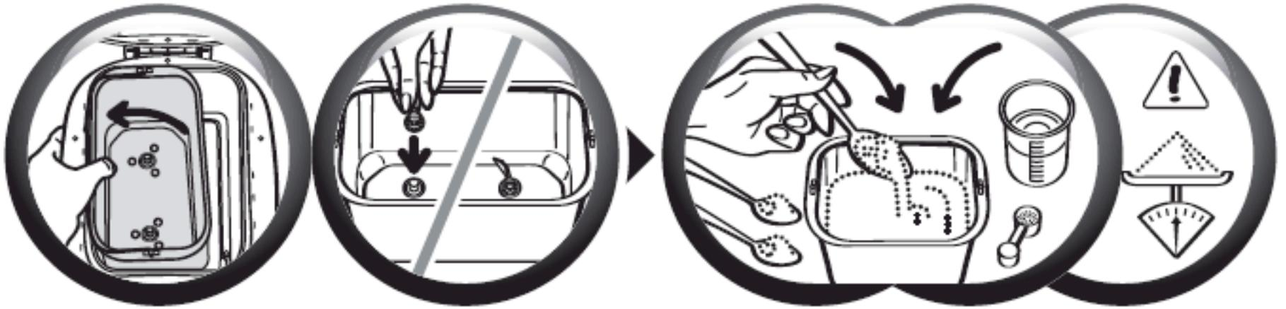
Retirez la cuve à pain en la basculant légèrement sur le côté pour la déclipser. Adaptez ensuite les mélangeurs.
