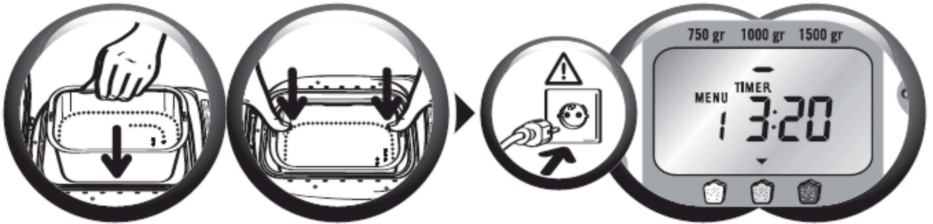
Introduisez la cuve à pain. Appuyez sur la cuve d'un côté puis de l'autre pour l'enclencher sur l'entraîneur et de manière à ce qu'elle soit bien clipsée des 2 côtés.
