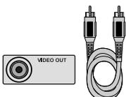
Prise et câble RCA pour signal Vidéo CVBS appelé également Composite.
