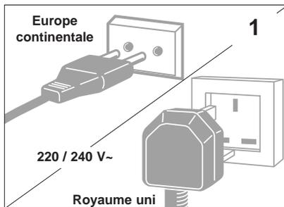
La prise est munie d'un fusible qui protège votre téléviseur. Si votre téléviseur ne fonctionne pas, le fusible est peut-être fondu. Dans ce cas remplacez-le par un fusible identique de 5 ampères certifié par l'ASTA ou le BSI (BS 1362).
