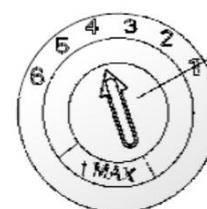
**REMARQUE :** Si la vaisselle est terne ou présente des taches circulaires, la quantité de liquide de rinçage doit être augmentée. Si la vaisselle est collante ou présente des rayures blanchâtres, la quantité de liquide doit être diminuée.
