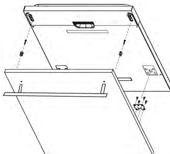
3. Retirez les quatre vis de l'intérieur de la porte du lave-vaisselle et fixez la porte du meuble à la porte du lave-vaisselle en insérant les quatre longues vis puis en les serrant.
