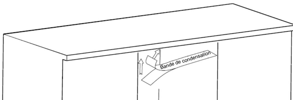
La bande de condensation doit être montée sur la face inférieure du plan de travail pour le protéger contre la pénétration de l'humidité.
