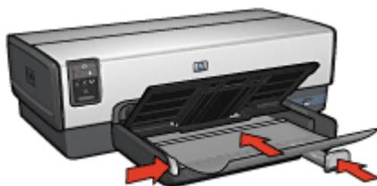
5. Poussez doucement les transparents dans l'imprimante jusqu'à ce qu'ils soient bien en place, de façon à ce que les bandes adhésives ne se chevauchent pas.
