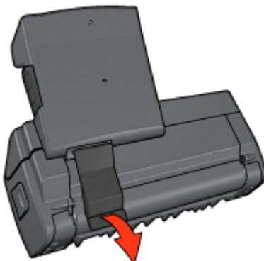
5. Faites basculer le bac à papier petit format vers l'avant et ouvrez la porte inférieure du module.
