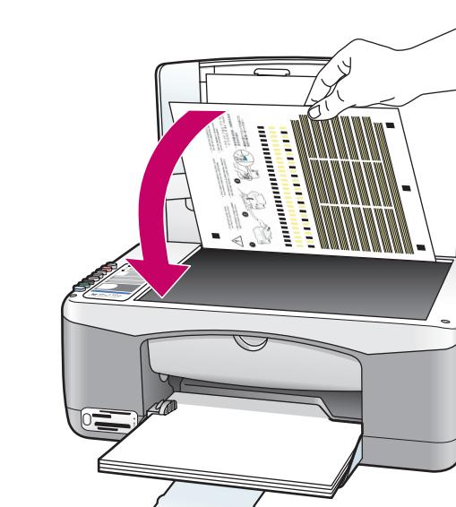
e Fermez la porte d'accès au chariot d'impression. Au bout de quelques minutes, une page d'alignement des cartouches d'encre s'imprime. Placez le haut de la page d'alignement, face imprimée vers le bas, dans l'angle inférieur gauche de la vitre. Fermez le couvercle.
