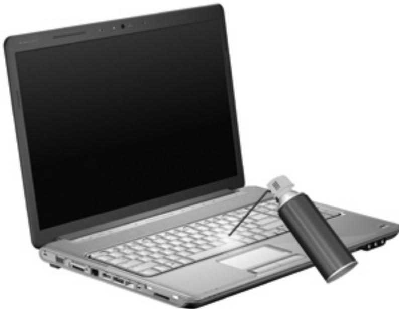
Si le clavier de l'ordinateur dispose d'un bouton de pointage, nettoyez-le régulièrement ou remplacez le capuchon du bouton de pointage. (Certains modèles sont livrés avec des capuchons pour le bouton de pointage.)
