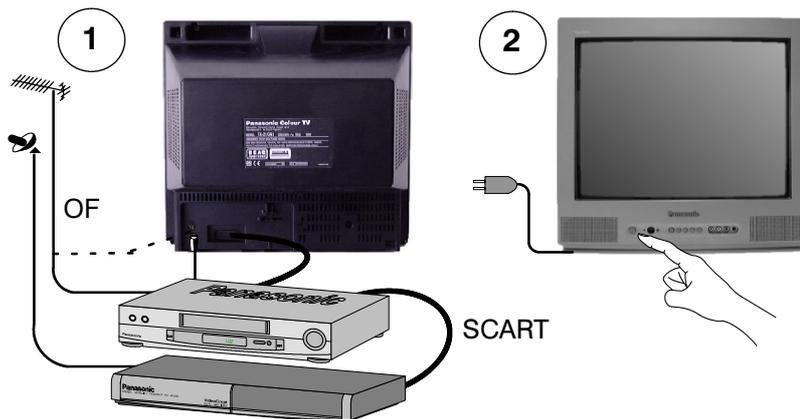
Sluit de stekkers van de antenne en de andere apparaten aan. Schakel de aangesloten toestellen in.
