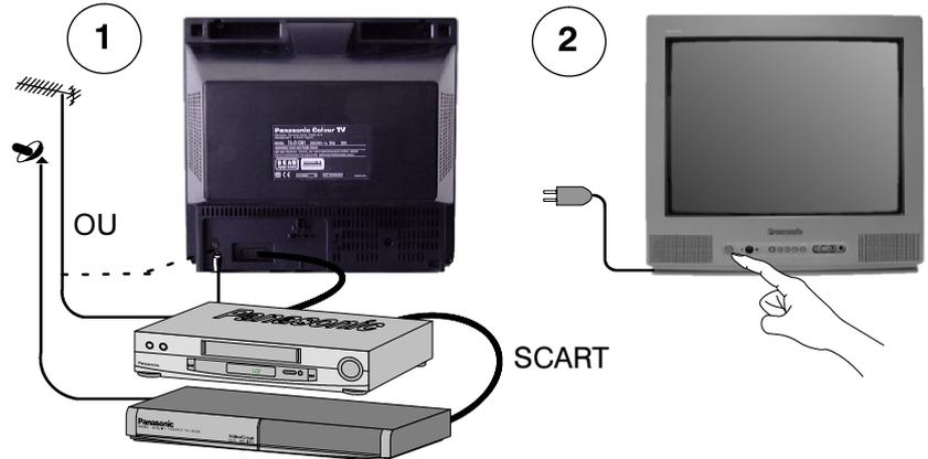
Branchez l'antenne et l'équipement auxiliaire. Allumez les postes branchés.
