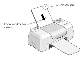
□ Vérifiez que la pile de papier ne dépasse pas la flèche matérialisée sur la face interne du guide latéral gauche. ☐ Pour de plus amples informations sur les capacités de chargement en supports spéciaux EPSON, reportez-vous au *Guide de référence* en ligne.
