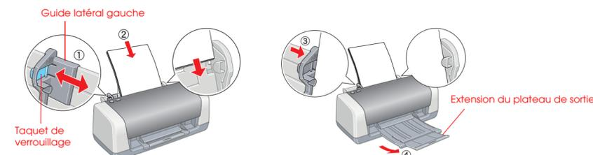
**Remarque :** Pour régler le guide latéral gauche, enfoncez le taquet de verrouillage et faites coulisser le guide afin de l'appuyer contre la pile de papier.
