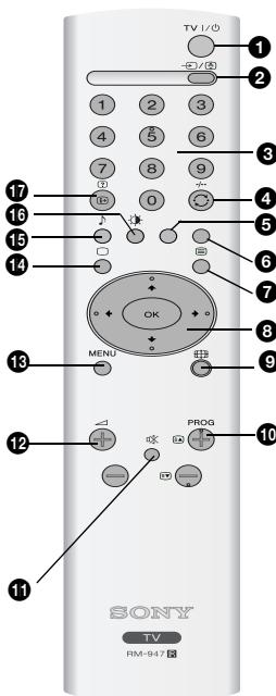
**1 Kurzzeitiges Ausschalten des Fernsehgerätes:** Drücken Sie diese Taste, um das Fernsehgerät vorübergehend auszuschalten (die Anzeige des Modus: Warten leuchtet auf). Drücken Sie die Taste nochmals, um das Fernsehgerät, ausgehend vom Bereitschaftsmodus (Standby) wieder einzuschalten. Um Energie zu sparen wird empfohlen das Fernsehgerät komplett auszuschalten, wenn es nicht gebraucht wird.
