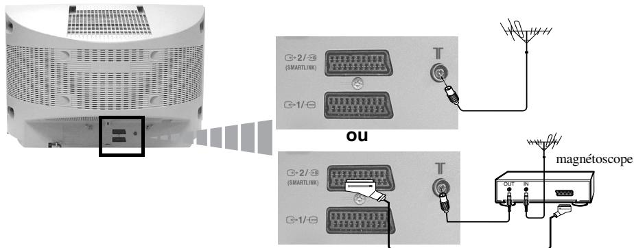
Pour de plus amples détails sur le branchement du magnétoscope, consultez le chapitre "Connexion des équipements en option" de ce mode d'emploi (voir page 18).
