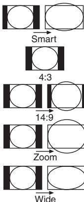
**Smart:** Simulation eines Breitbildeffekts bei 4:3-Sendungen.
