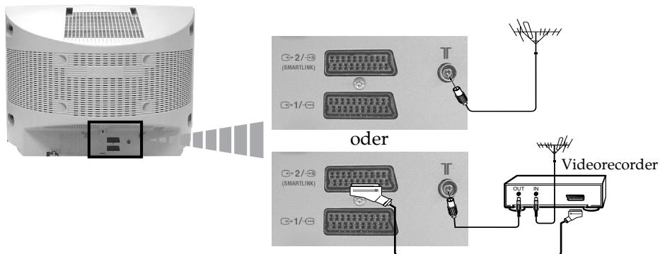
Der Anschluss mit Hilfe der Eurobuchse ist frei wählbar.
