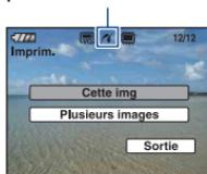
L'appareil passe en mode de lecture, puis une image et le menu d'impression apparaissent à l'écran.
