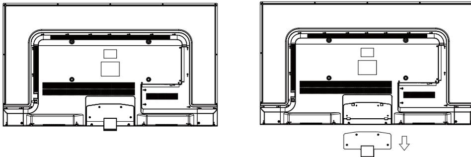
3. Utilisez les quatre vis fournies pour fixer le téléviseur sur un support mural (non inclus) par les quatre trous VESA standard à l'arrière du téléviseur.
