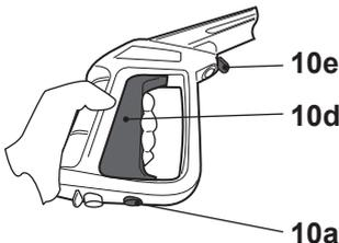
Fig. 23, verrouillage activé; la gâchette est bloquée en position arrêt
