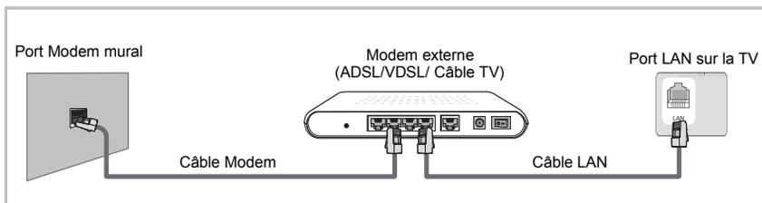
Vous pouvez connecter le téléviseur à votre réseau local en connectant le port LAN situé à l'arrière de votre téléviseur à un routeur IP connecté à un modem externe.
