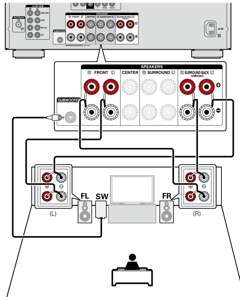
Installez les enceintes et connectez-les d'abord à cet appareil.
