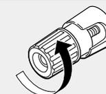
**3** Insérez le fil conducteur du câble d'enceinte dans la garde de la borne de l'enceinte.
