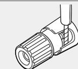
**4** Tournez la borne de l'enceinte dans le sens des aiguilles d'une montre pour la resserrer.
