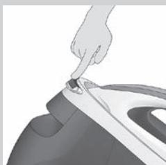
**4** Pulse el botón de liberación del bloqueo para transporte para desbloquear la plancha de su plataforma.
