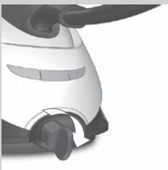
**5** Lorsque toute l'eau est sortie de l'appareil, réinsérez le bouton EASY DE-CALC et tournez-le dans le sens des aiguilles d'une montre pour le fixer à nouveau.
