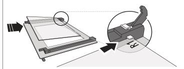
**4.** Replacez le bord supérieur : un déclic indique le positionnement correct. Assurez-vous que le joint est bien placé avant de replacer la porte.
