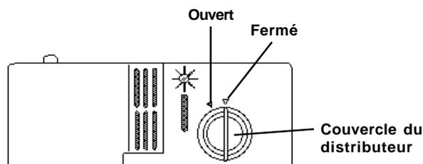
1. Pour ouvrir le distributeur, tournez le couvercle jusqu'à la flèche "open" (à gauche) et soulevez-le.
