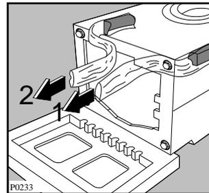
Remettez la machine debout et dévissez les 2 autres vis à l'arrière.
