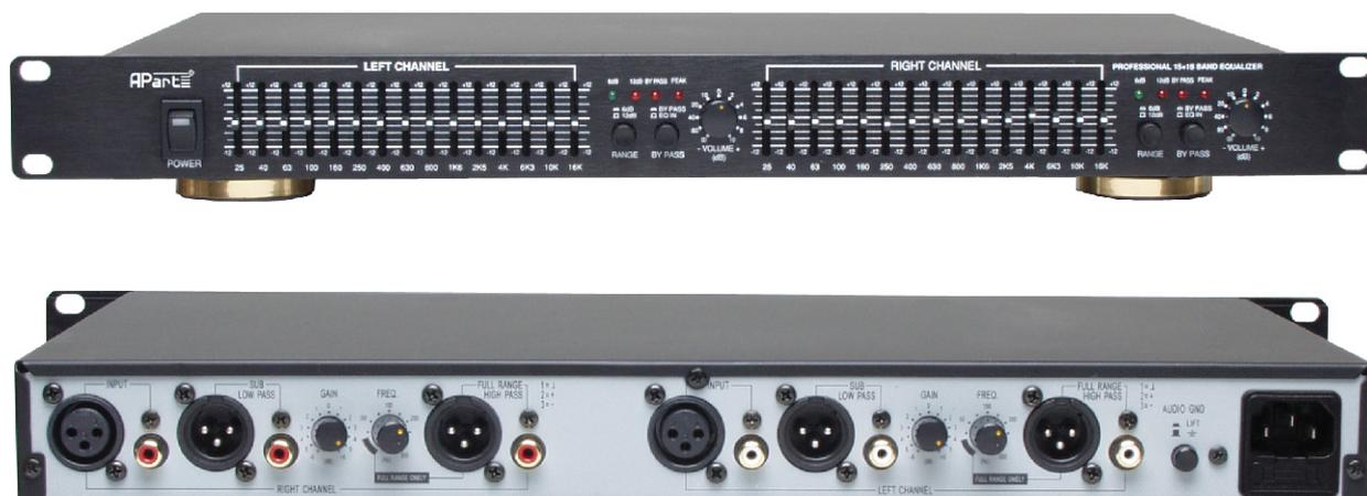
Le PXQ2215 APart ressemble à un égaliseur 2 x 15 bandes standard, mais c'est en réalité bien plus. Le PXQ2215 associe la section d'égalisation à un filtre répartiteur (crossover) 2 voies réglable à l'arrière. Tourner le potentiomètre de fréquence à fond à gauche donne une sortie large bande.
