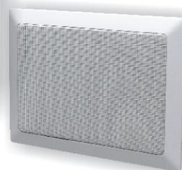
Le CMR20T APart est un haut-parleur rectangulaire compact intégré à 2 voies. Il peut fonctionner sous 16 ohms ou en 100 volts. En utilisation 16 ohms, vous pouvez brancher jusqu'à 4 haut-parleurs en parallèle sur chaque canal d'un amplificateur 4 ohms standard. Pour l'emploi en 100 volts, le CMR20T est équipé d'un transformateur 20 watts sous 100 volts de haute qualité ayant plusieurs réglages de puissance. Ces réglages se font via un sélecteur masqué derrière la grille du haut-parleur.
