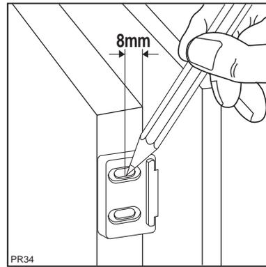
9. Enlevez les équerres et faites des trous de  $\varnothing$  2 mm. Remettez les équerres au-dessus des guides et vissez le tout avec les vis fournies en accessoires (3,5x 16 mm).
