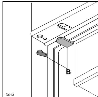
7. Posez les guides (H) à l'intérieur de la porte du meuble, en haut et en bas, comme l'illustre la Fig., et repérez la position des trous extérieurs. Après avoir préparé les trous, vissez les guides avec les vis de 3,5x 16 mm sur la porte du meuble.
