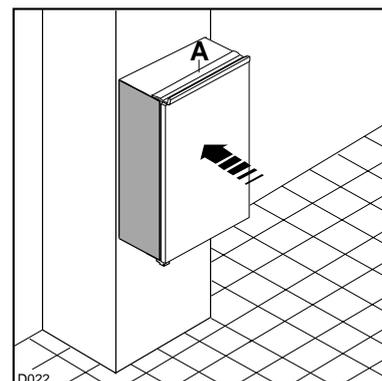
3. Si après l'opération décrite au point 2 devait rester une fissure entre l'appareil et le meuble, appliquer sur la butée (A) le joint livré à cet effet.
