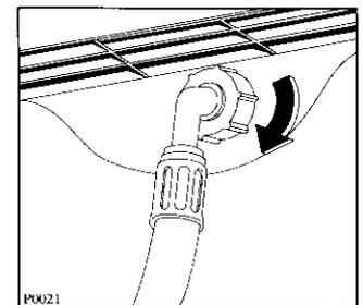
L'autre extrémité du tuyau d'arrivée, du côté de la machine, peut être orientée dans n'importe quelle direction. Dévisser un peu la bague de serrage, tourner le bout du tuyau et revisser solidement la bague.
