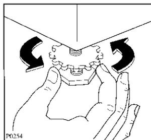
Placer la machine à laver dans sa position définitive et la mettre autant que possible de niveau, en vissant ou en dévissant un ou deux des vérins d'appui réglables. Veiller à ce que la machine soit bien stable sur les quatre vérins. Après la mise de
