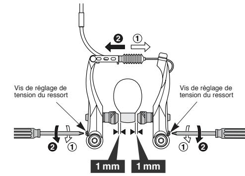
6. Enfoncer environ 10 fois le levier de frein jusqu'à la poignée et vérifier que le système fonctionne parfaitement et que l'écart de patin est correct avant d'utiliser les freins.
