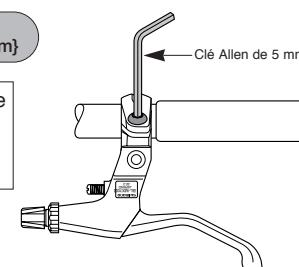
Lors de l'installation de composants sur les surfaces cadre/guidon en carbone, consulter les recommandations du fabricant du cadre/des pièces en carbone en matière de couple de serrage de manière à éviter tout serrage excessif qui pourrait endommager le carbone et/ou tout serrage insuffisant qui pourrait entraîner un manque de fixation au niveau des composants.
