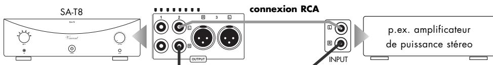
Vous avez la possibilité d'utiliser simultanément toutes les trois sorties stéréo du préamplificateur et avec elles alimenter jusqu'à 6 canaux des amplificateurs de puissance et leurs haut-parleurs. Pour cela vous aurez besoin de connecter les connexions de sortie jusqu'alors laissées libres (8) avec plus de canaux d'amplificateurs de puissance.
