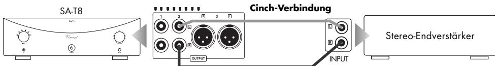
Sie haben die Möglichkeit, alle drei Stereo-Ausgänge des Endverstärkers gleichzeitig zu nutzen und somit bis zu 6 Endstufenkanäle und deren Lautsprecher zu versorgen. Dazu brauchen Sie lediglich die bisher freibleibenden Ausgangsanschlüsse (8) mit weiteren Endverstärkerkanälen zu verbinden.
