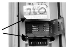
dorés doivent être placés vers l'intérieur. Vérifiez également que le coin coupé est bien placé dans le même sens que le coin rogné du support SIM.
