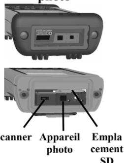
Un cache de protection, vendu séparément en tant qu'accessoire peut être utilisé pour protéger les cartes CompactFlash (CF) et Secure Digital (SD).
