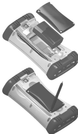
Retirer le bouchon de protection situé à l'extrémité du stylet de façon à dégager un tournevis Philips ou utiliser un petit tournevis Philips N°1 pour serrer les quatre vis du couvercle du logement de la batterie.
