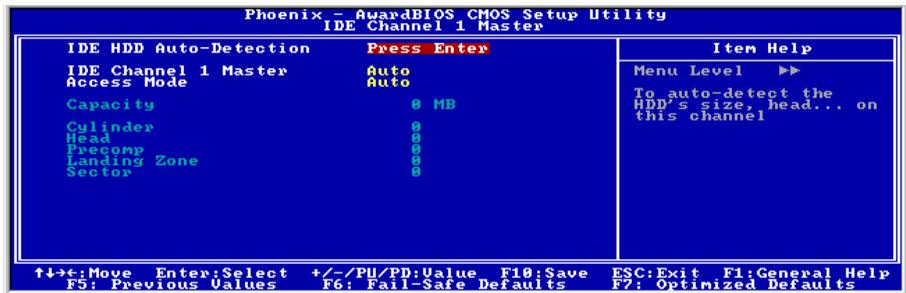
**Remarque:** Les éléments “IDE Channel 3 Master” et “IDE Channel 4 Master” n’apparaissent que lorsque l’élément “OnChip Serial ATA” dans le menu “OnChip IDE Device” est programmé sur [Mode Amélioré], et que l’élément “OnChip Serial ATA Mode” dans le menu “OnChip IDE Device” est programmé sur [IDE].
