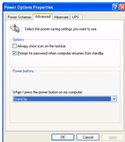
2. Sélectionnez “**Paramètres Avancés**”, et puis configurez le bouton “**Power**” du boîtier en mode “**Mise en Veille**”.
