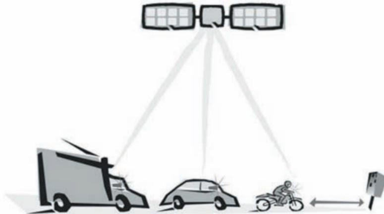
Lorsque vous vous approchez d'un radar fixe, INFORAD vous alerte visuellement 20 secondes avant et environ 200 mètres au-delà. Ces paramètres sont configurables par INFORAD MANAGER qui peut être téléchargé à partir du site web INFORAD : [www.gpsinforad.com](http://www.gpsinforad.com).
