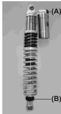
Pour ajuster l'extension, tourner manuellement la commande (B) de la partie inférieure de l'amortisseur.
