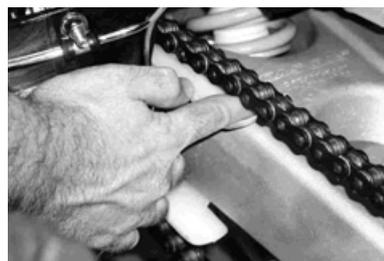
L'espace de tension entre la chaîne et le bras du basculeur à la hauteur du patin de la chaîne doit être d'un doigt ; s'il est supérieur ou inférieur, il faut l'ajuster à la mesure correcte. Suivre la procédure que nous décrivons ci-après :
