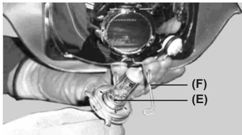
(F). Fils de fer de fixation de l'ampoule.
