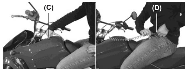
L'extrémité (C) sera fixée au véhicule, et l'extrémité (D) sera fortement fixée au pilote.
