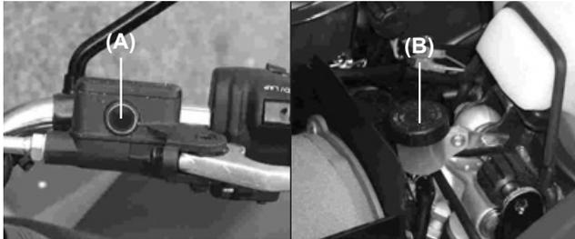
(A) ET (B). Réservoirs de liquide de freins avant et arrière.
