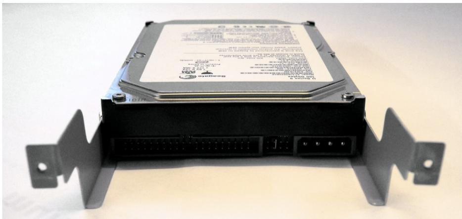
Faites attention de monter convenablement le disque dur dans la berceau du disque dur. Placez le jumper du disque dur pour le câble choisi. Cette information est d'habitude inscrite sur le disque dur.
