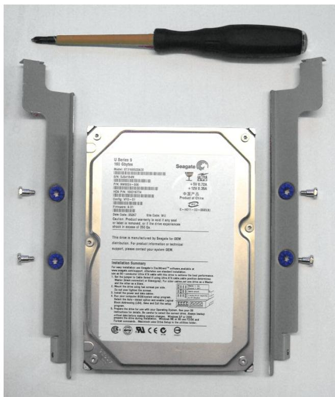
Maintenant vous avez besoin du tournevis Phillips, du berceau du disque dur, des 4 vis de support du disque dur et votre disque dur.
